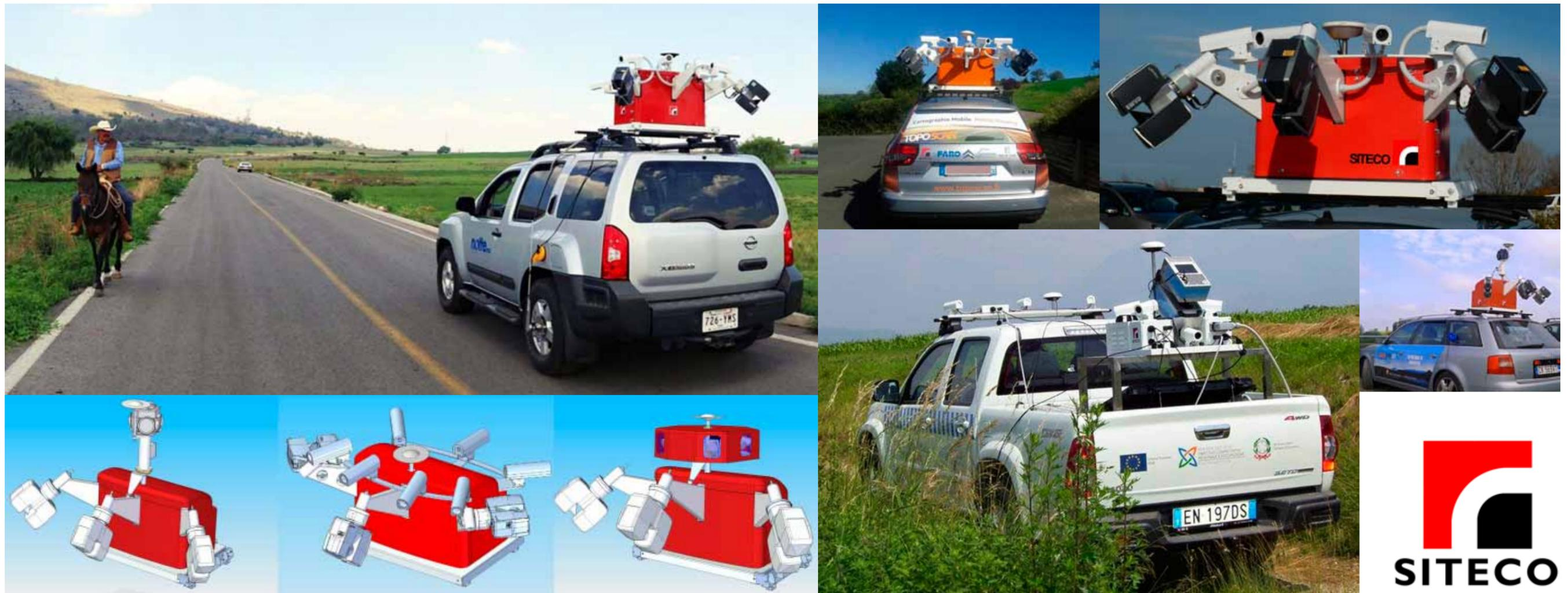
Road-Scanner ad alto rendimento dotato di tecnologia laser-scanner.
