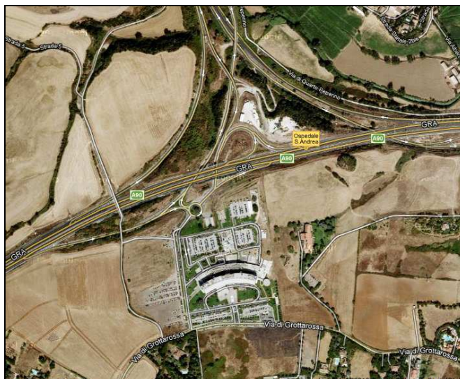
Foto satellitare tratta da Google Maps che lascia vedere il cosiddetto “svincolo a trombetta” sul G.R.A. per l’Ospedale S. Andrea
